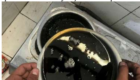
Gambar 2. Proses penyaringan dan pemurnian minyak jelantah.
